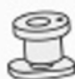
1 Grzybkowe elementy trzpieni na skrzydle
